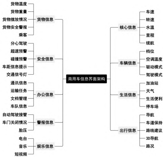
图3 商用车AR-HUD信息界面架构
